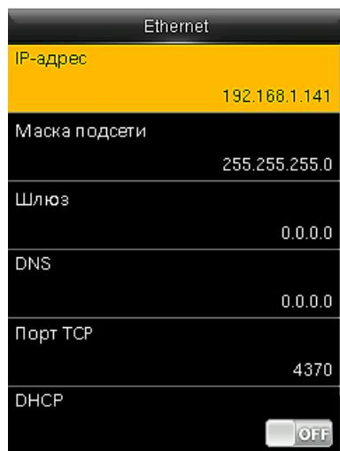
**IP-адрес:** при необходимости его можно изменить. Он должен отличаться от IP-адреса на Вашем ПК.
